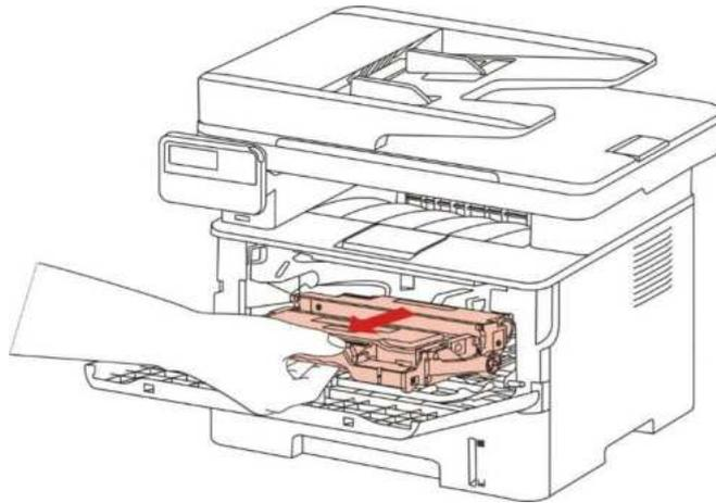
**الملاحظات:** • عند إسقاط خرطوشة حبر الليزر، عي خرطوشة حبر الليزر إلى الكيس الوقائي أو تعبئة الأوراق السميكة، تجنب ضرر الأسطوانة الحساسة للضوء بالأشعة.
