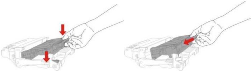
7. خذ مكونات خرطوشة الحبر المركبة ويركب مكونات خرطوشة الحبر عبر المسار داخل آلة الطباعة لإكمال التركيب.
