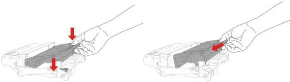
6. خذ مكونات خرطوشة الحبر المركبة وركب مكونات خرطوشة الحبر عبر المسار داخل آلة الطباعة لإكمال التركيب.
