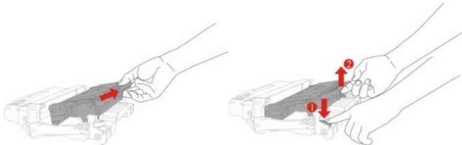
4. افتح تعبئة المكونات الجديدة وأسقط جهاز حماية المكونات وضعها على سطح المنصة الأفقية.
